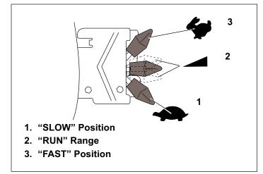
Figure 27. Start/Choke Control Positions
