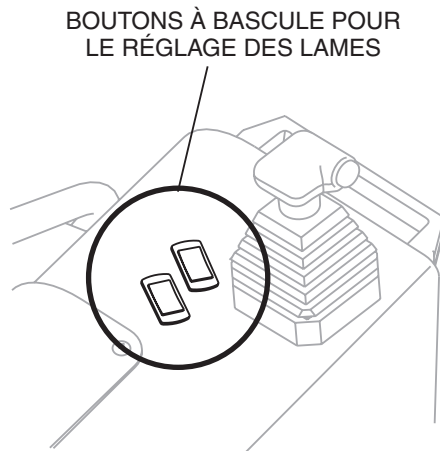
Figure 30. Interrupteurs à bascule de réglage de l'inclinaison des lames
