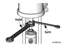
Fig. 7. Loosen the coupling nut.
