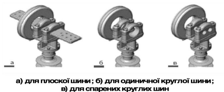
Рис. 2. Конструкція струмових головок ОТС виробництва NxtPhase Corporation
