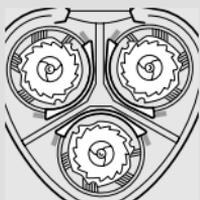
**4** Vyjímte holicí hlavy a nové vkládejte do holicí jednotky vždy tak, aby část s malými otvory směřovala do středu holicí jednotky.
