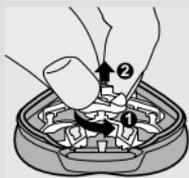
**2** Lai atvērtu skūšanas bloku, piespiediet atbrīvošanas slēdzi.
