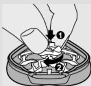
**5** Załóż ponownie obsadę na moduł golący, wciśnij kółko i obróć nim w kierunku zgodnym z kierunkiem wskazówek zegara.
