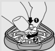
**5** Stavite nazad pričvršni okvir, pritisnite kotačić te ga okrenite u smjeru kazaljke na satu.
