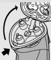
**2** Pritisnite tipku za otpuštanje za otvaranje brijaaće jedinice.
