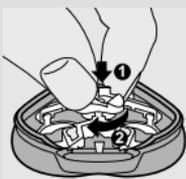
**4** Uklonite glave za brijanje, i u jedinicu za brijanje postavite nove glave tako da su delovi sa malim otvorima usmereni prema centru jedinice za brijanje.
