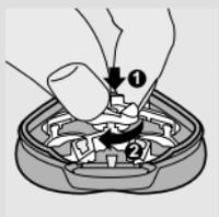
**5** Zajišťovací rámeček vložte zpět do přístroje, stiskněte kolečko a otočte jím ve směru pohybu hodinových ruček.
