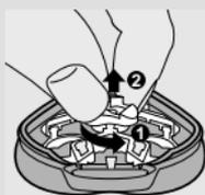
**2** Wciśnij przycisk blokujący, aby otworzyć element golący.
