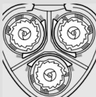
**4** Uklonite brijaaće glave te stavite nove u brijaaću glavu na način da dijelovi s malim rupicama budu usmjereni prema centru brijaaće glave.
