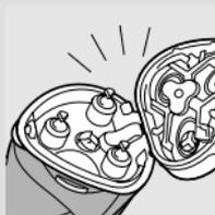
**6** Atkal atveriet skūšanas bloku un atstājiet atvērtu, lai tas pilnīgi izžūst.
