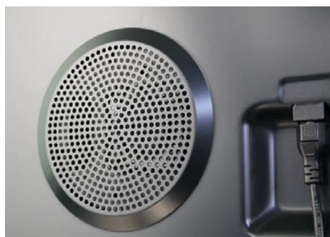
Il TV LG 860 offre un discreto sistema audio 2.1. Il subwoofer è disposto nella parte posteriore
