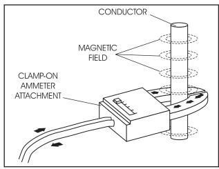
Figure 2-2. – Clamp-On Ammeter
