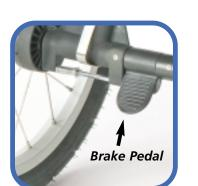
JOGGER IS PACKAGED WITH THE HAND BRAKE ASSEMBLY LOOSE. TIGHTENING IS NECESSARY FOR SAFE OPERATION!
