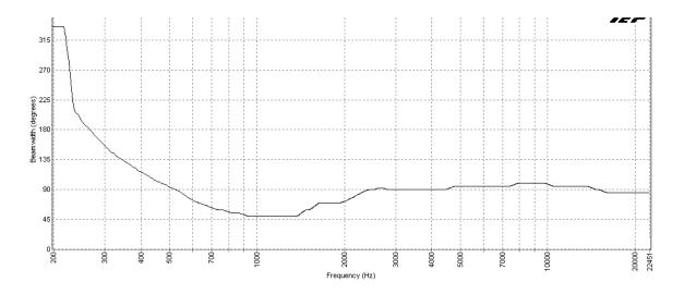
AH94-12ST Horizontal Beamwidth (- 6dB)
