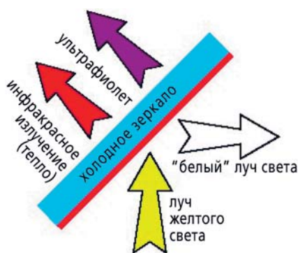
Рис. 3. Трансформация луча в ламповом модуле
