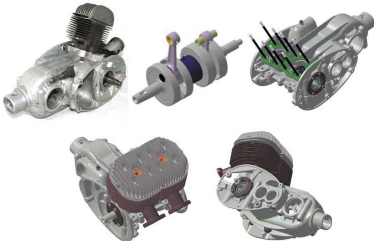
Rys. 8. Wykonanie złożenia. U góry po lewej fizyczny egzemplarz silnika, wykorzystany do pomiarów.
