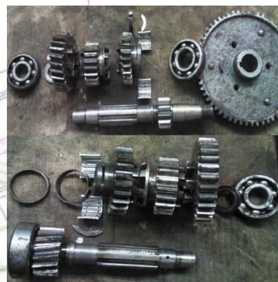
Rys. 9. Elementy skrzyni biegów
